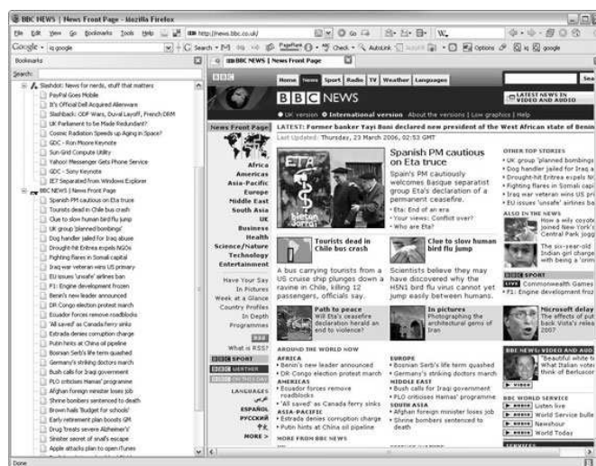
图 4.2 RSS 阅读器图示，左侧栏中为 RSS feed 及 feed 中的新闻标题；右侧栏是点击某标题后得到的新闻正文。RSS 在线阅读的网页布局与此类似。该图引用自参考文献 [16]。
